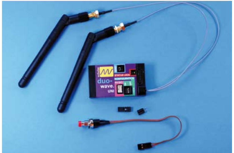
Das Duo-wave.UNI-Modul und der Sicherheitsschalter S3D-switch-it passen problemlos in die meisten Fernsteueranlagen von Graupner/JR, robbe/Futaba und Multiplex
