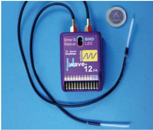
Beim High-End-Empfänger \mu wave-12 können RC-Piloten zwischen insgesamt sieben verschiedenen Antennenformen wählen. Hier der \mu wave-12.FA mit schraubbaren Antennen
