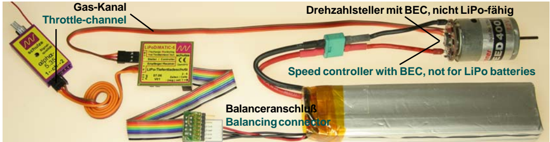
Verdrahtungsbeispiel 1 / Typical wiring arrangement 1
