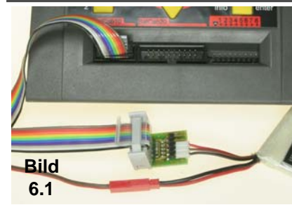
Bild 6.1: Anschluß eines 2s...4s-Packs über ein BalAd-TP4 oder BalAd-Ko4 und einem BalCab10-Verl an das next-Generation , LiPoCard, LiPoProfiBal... 2*5s-Pack am BalAd-Ko12 - Bild 6.2
