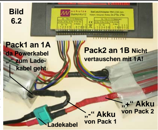
Bild 6.1: Anschluß eines 2s...4s-Packs über ein BalAd-TP4 oder BalAd-Ko4 und einem BalCab10-Verl an das next-Generation , LiPoCard, LiPoProfiBal... 2*5s-Pack am BalAd-Ko12 - Bild 6.2
